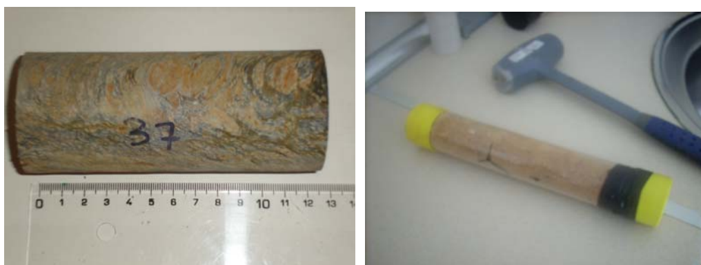
Fig. 3.49 Testigos preparados para medición en el equipo de testificación Multi-sensor Core Logger (MSCL)
