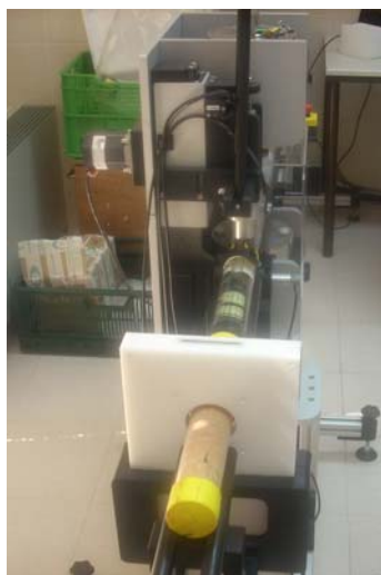
Fig. 3.50 Medidas en testigos en el equipo de testificación Multi-sensor Core Logger (MSCL)
